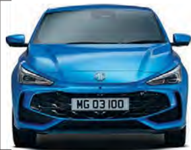
Rozstaw kół przednich 1510 mm Szerokość z lusterkami 2014 mm
